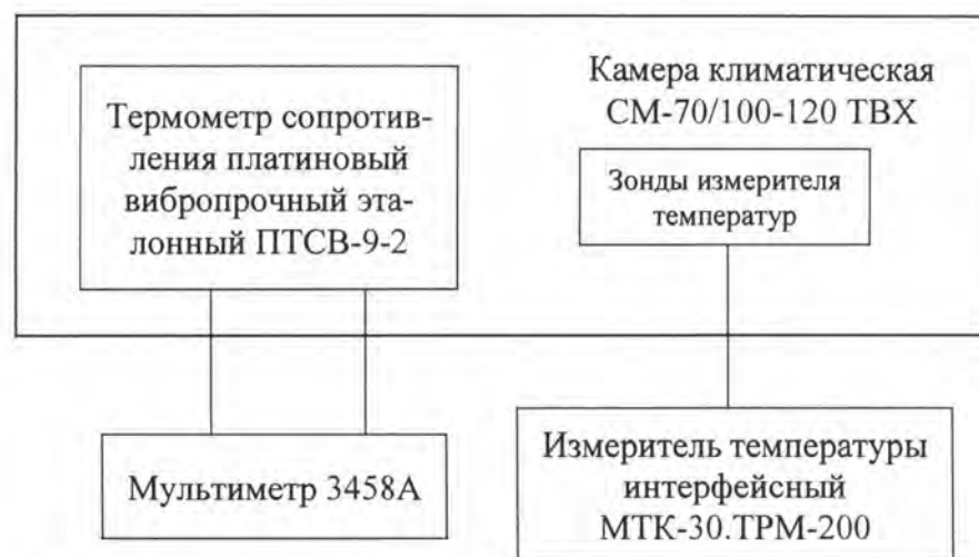
Рисунок 1 – Схема для проверки допустимой абсолютной погрешности измерения температуры окружающей среды
