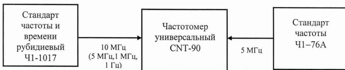
Рисунок 7.1 – Структурная схема подключения приборов для измерения номинального значения частоты выходных сигналов
