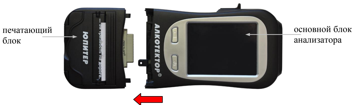
Рисунок 31 – Отсоединение печатающего блока
