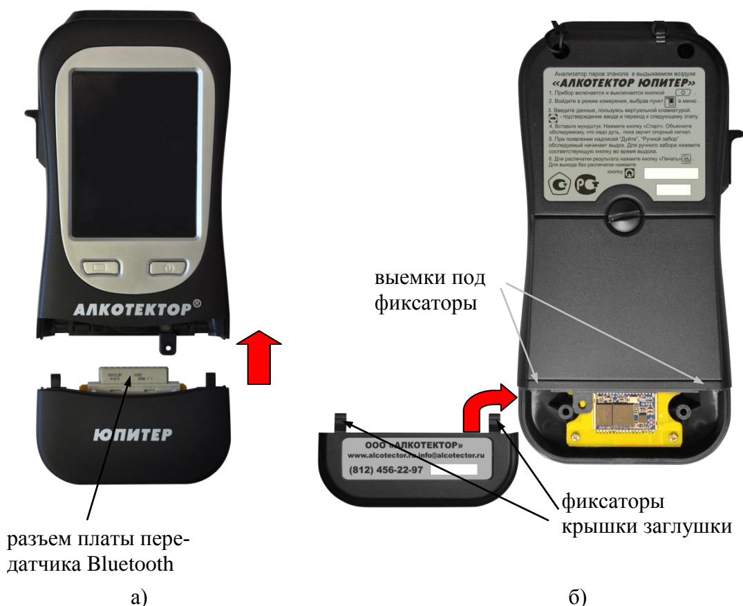
Рисунок 32 – Подсоединение заглушки к основному блоку анализатора
