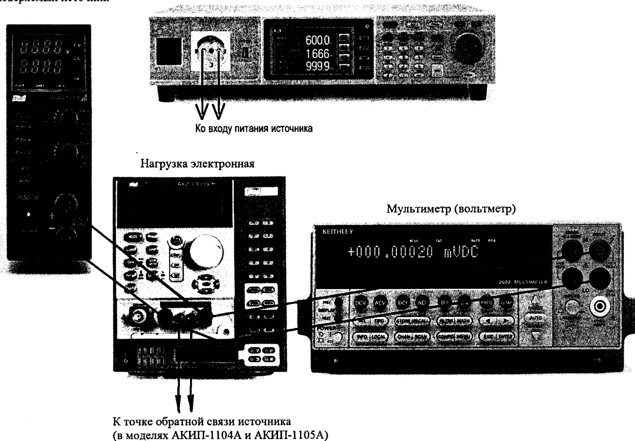
Рисунок 1 - Схема соединения приборов для определения основных метрологических характеристик источников питания в режиме стабилизации напряжения.
