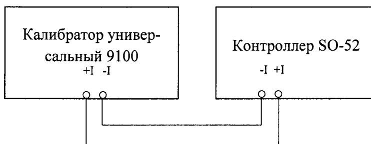
Рисунок 4 – Схема подключения при измерении силы постоянного тока
