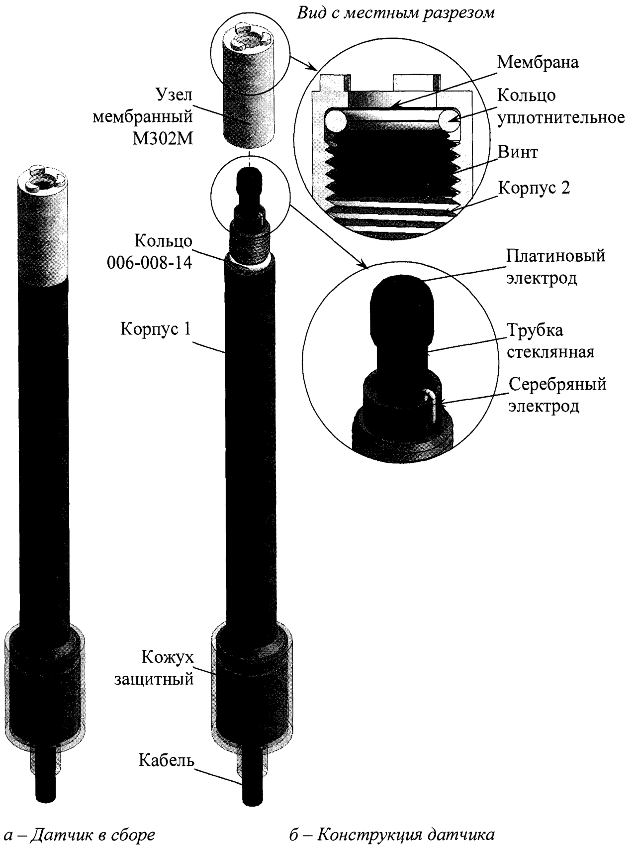
Рисунок 1.4 – Датчик кислородный ДК-302М
