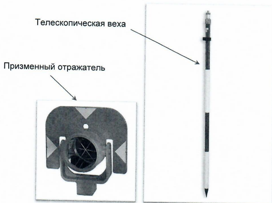
Рисунок А.1 – Веха телескопическая с призмным отражателем
