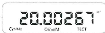
Рисунок 3 – Жидкокристаллический дисплей в режиме «Поверка»
