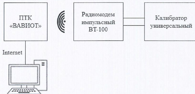
Рисунок 3 – Схема подключения для определения относительной погрешности измерения и преобразования количества импульсов электрического напряжения
