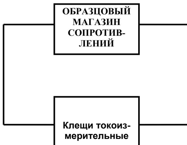
Рис. 7.2. Схема соединений при проверке погрешности прибора в режиме измерения сопротивления.
