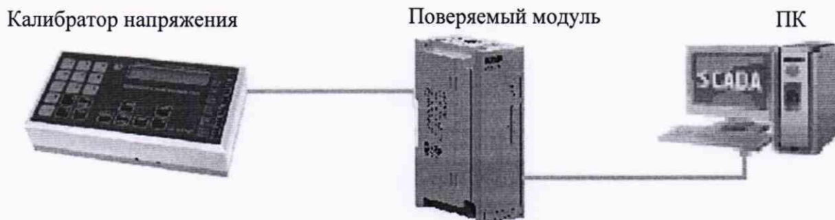
Рисунок 8 – Схема определения основной приведенной (к диапазону измерений) погрешности измерений (преобразований) при измерении входных сигналов от датчиков с сигналами напряжения постоянного тока
