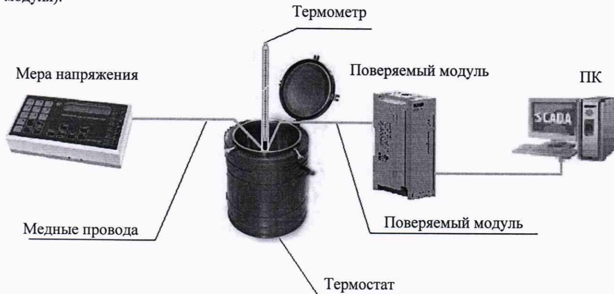
Рисунок 5 – Схема определения основной приведенной (к диапазону измерений) погрешности измерений (преобразований) при измерении входных сигналов от термоэлектрических преобразователей
