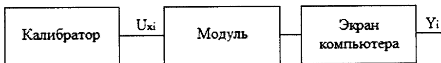
Рисунок 2 - Схема подключений при определении погрешностей ИК, реализующих аналого-цифровое преобразование сигналов от термопар
