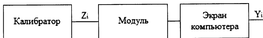
Рисунок 1 - Схема подключений при определении погрешностей ИК, реализующих линейное аналого-цифровое преобразование сигналов силы или напряжения постоянного электрического тока
