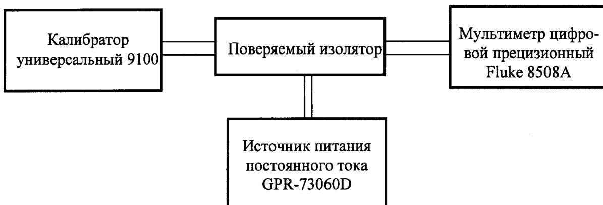
Рисунок 1 – Структурная схема опробования и определения абсолютной основной погрешности преобразований
