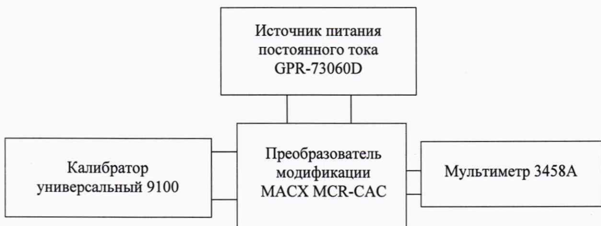
Рисунок 4 – Схема подключений для поверки преобразователя модификации MACX MCR-CAC
