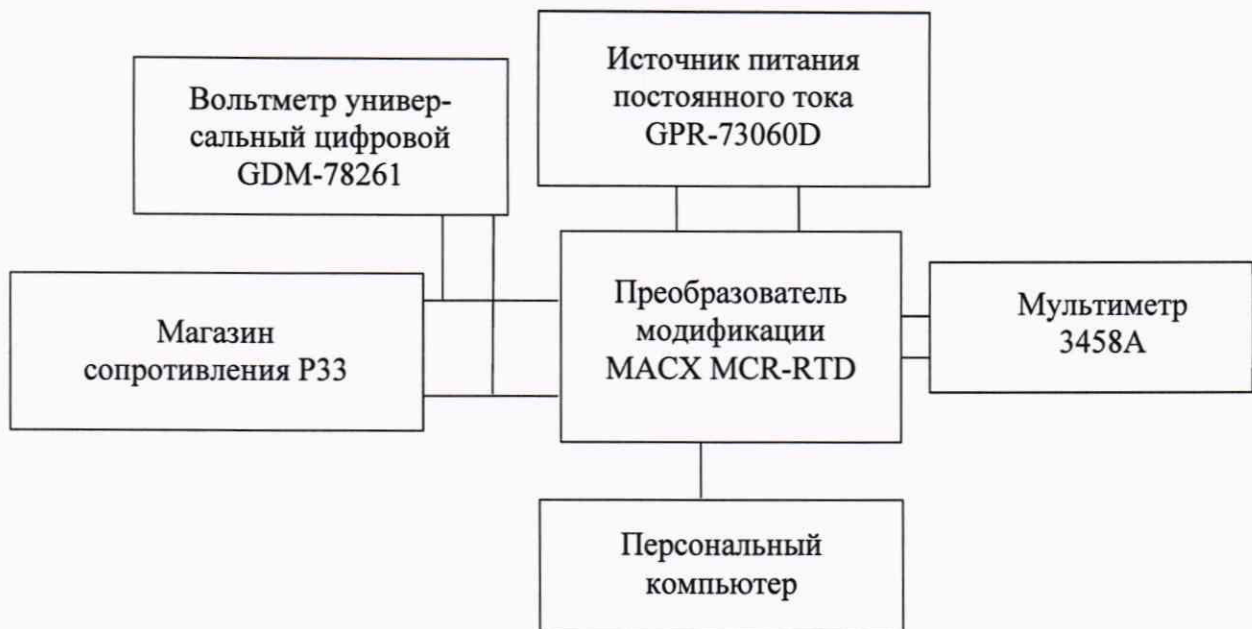
Рисунок 3 – Схема подключений для поверки преобразователя модификации MACX MCR-RTD
