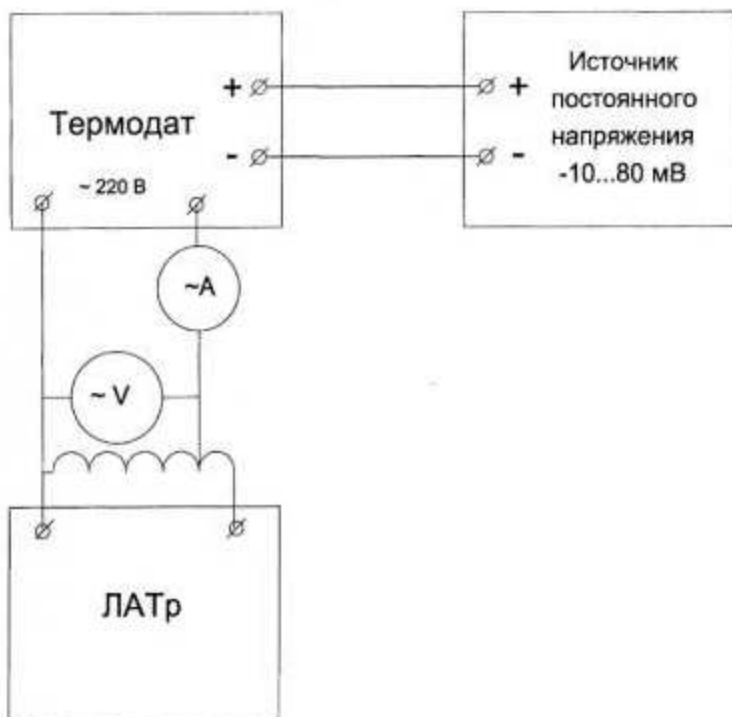
Рис.1 Схема подключения прибора при проверке потребляемой мощности
