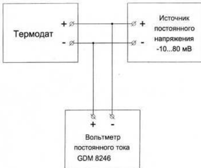
Рис.3. Схема подключения прибора при проверке диапазона измерения температуры и основной приведенной погрешности измерения приборов, работающих с термопарами
