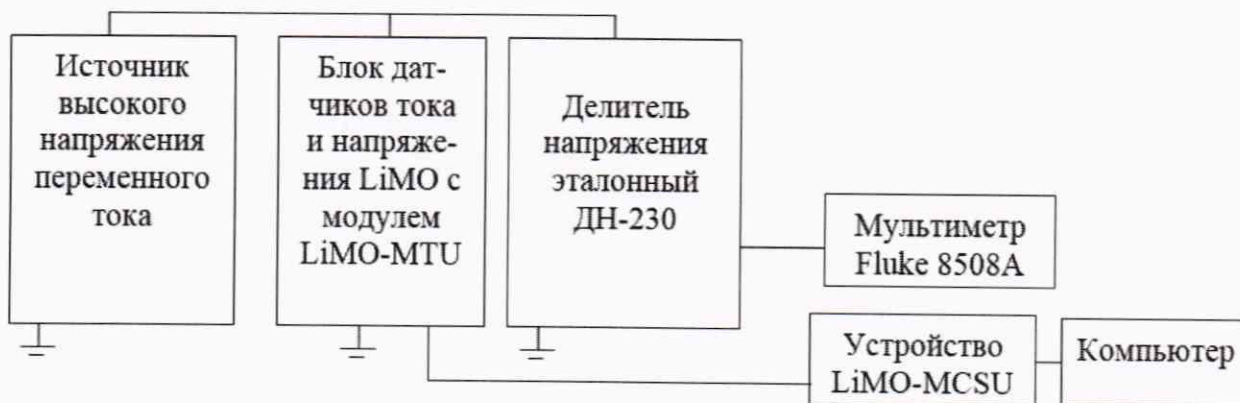
Рисунок 2 - Схема измерений на напряжении переменного тока свыше 1000 В
