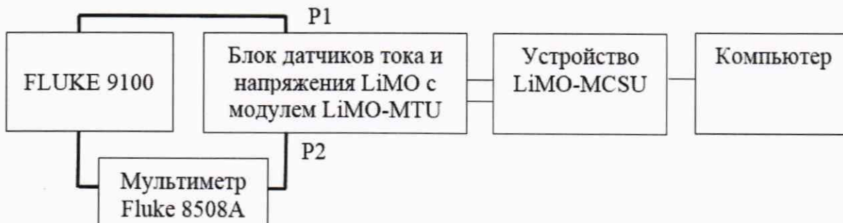
Рисунок 3 - Схема измерений силы переменного тока до 20 А
