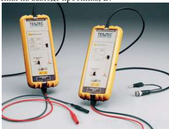
Рисунок 5 – Пробник-делитель для определения уровня пульсаций
