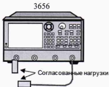
Рисунок 4 - Проверка уровня собственных шумов приемника
