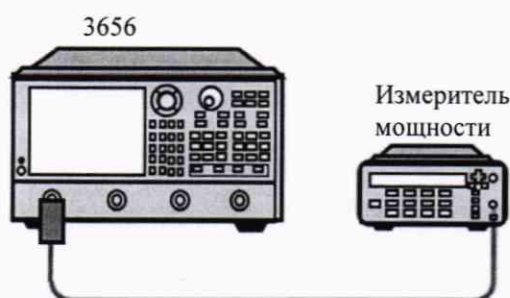
Рисунок 2 - Схема подключения измерителя мощности для проверки диапазона регулировки мощности.
