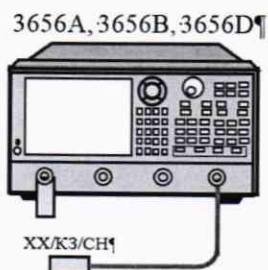
Рисунок 5 - Схема полной двухпортовой калибровки
