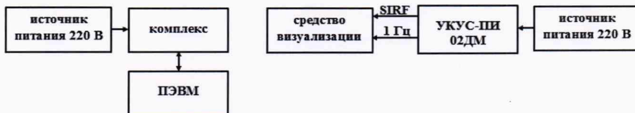
Рисунок 3 - Схема проведения измерений при определении погрешности синхронизации (штамп времени на кадре)
