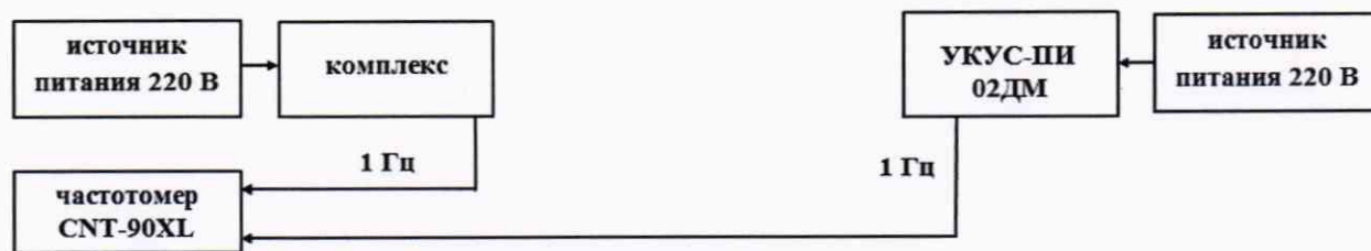
Рисунок 2 – Схема проведения измерений при определении абсолютной погрешности синхронизации внутренней шкалы времени комплекса (1 PPS) с национальной шкалой координированного времени UTC(SU)
