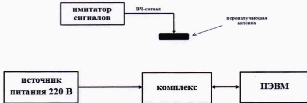
Рисунок 2 - Схема проведения измерений при определении инструментальной погрешности определения координат
