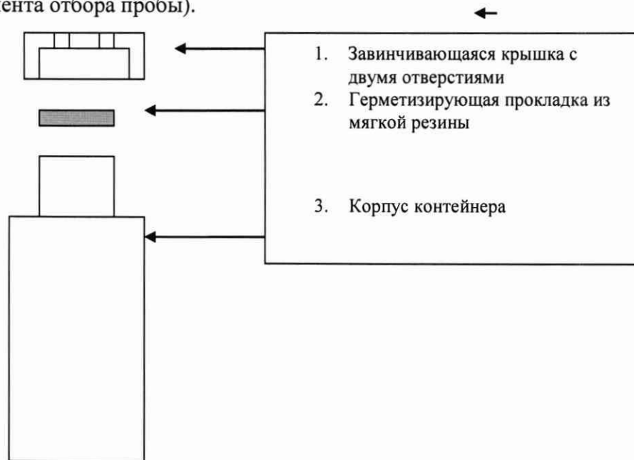
Рисунок 1. Схема контейнера для отбора проб с герметизирующей прокладкой.
