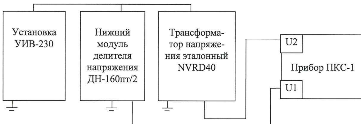
Рисунок 1 - Схема проверки при 35/\sqrt{3} кВ // 100/\sqrt{3} В
