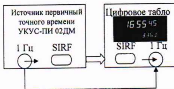
Рисунок 7 – Схема подключения УКУС-ПИ 02ДМ
