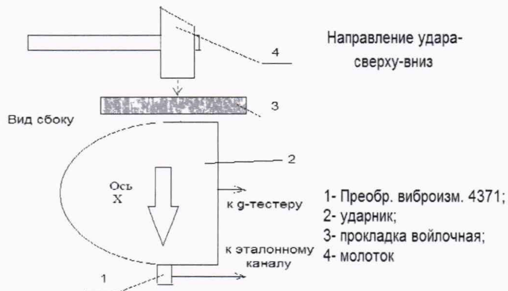
Рисунок А.5 – Схема подключения системы при определении диапазона измеряемых ускорений и относительной погрешности измерений ударного ускорения по оси X
