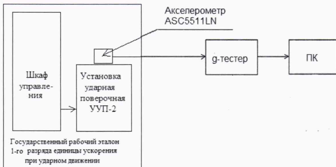
Рисунок А.3 – Схема подключения системы при определении нелинейности амплитудной характеристики в диапазоне амплитуд ударного ускорения от 10 g до 100 g
