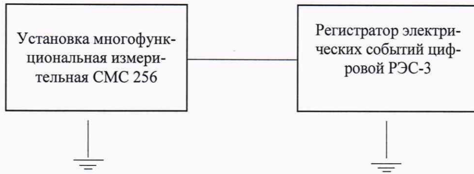
Рисунок 1 – Структурная схема определения погрешностей измерений напряжения постоянного/переменного тока, силы постоянного/переменного тока, частоты переменного тока
