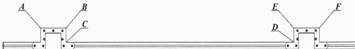
Рисунок 2 – Калибровочная линейка ДКП.999.15.061.00 с указанием контрольных точек
