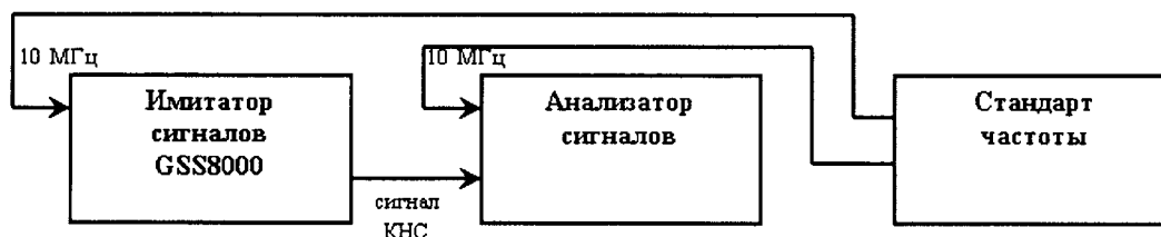
Рисунок 2 – Схема измерений для определения уровня гармонических составляющих
